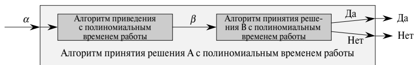
Рис. 34.1. Решение задачи принятия решения A в течение полиномиального времени с помощью алгоритма приведения с полиномиальным временем работы и известного алгоритма с полиномиальным временем работы, предназначенного для решения другой задачи B
